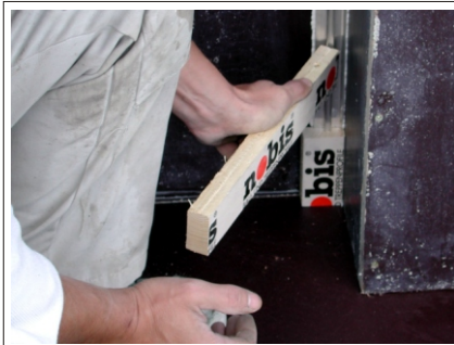
Bild 20: Profil mit der Hand oder einem Hammer fest in die Form schlagen, damit zu viel aufgetragener Kleber nach außen gepresst wird.
