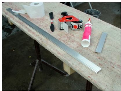
Bild 01: Materialien und Werkzeuge: Elch-Montagekleber, Abroller für Tesapack-Band, Lanzette, Profilrest o.ä. zum Abschneiden der Tesasüberstände und Papier zum Reinigen
